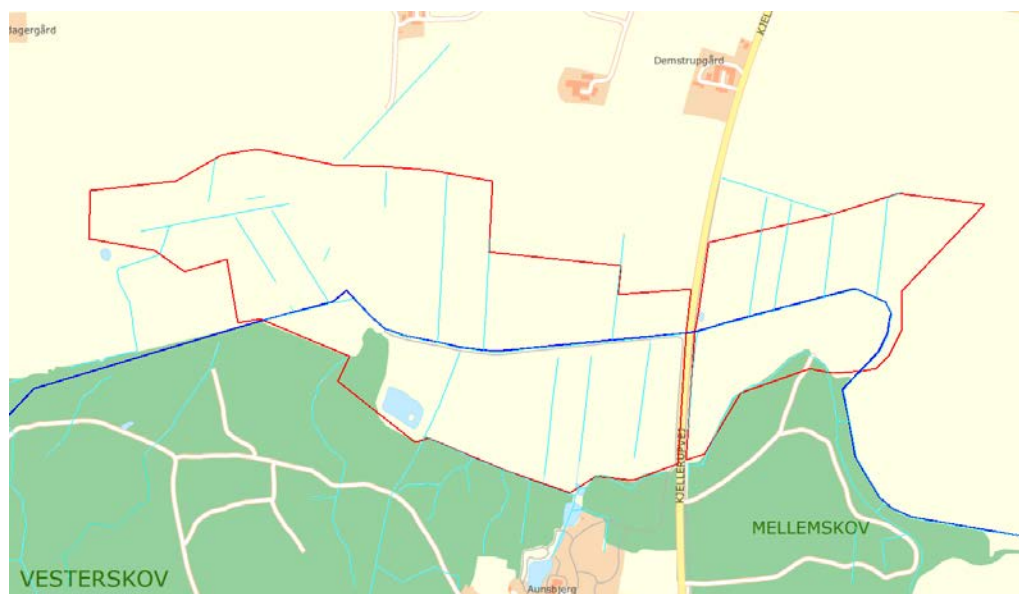
Figur 2.1.2: Oversigt over vandløb og grøfter i projektområdet. Mørkeblå streg er Levring Bæk, som nedstrøms Kjellerupvej (mod øst) er offentligt vandløb. Lyseblå streger er grøfter.
